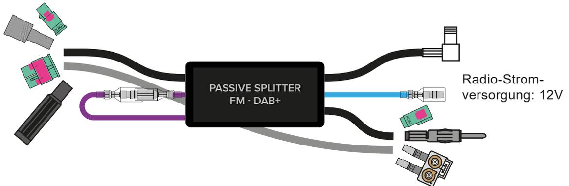
**Kabelbrücke:** Geschlossen: 12V; Offen: 8,5V (Wenn geöffnet: isolieren!)
