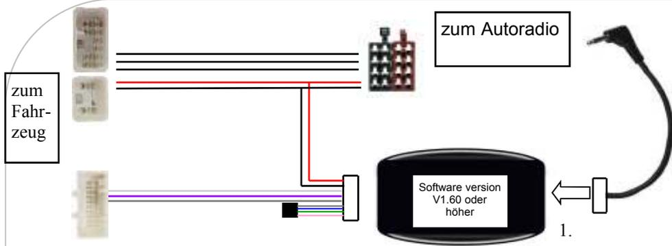
**1-Immer den Radioadapter anschliessen bevor die Zündung eingeschaltet wird!**
