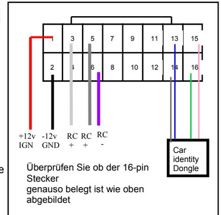
1. Wählen Sie einen Adapter passend zu Ihrem neuen Radio aus, (auf der Rückseite finden Sie eine Übersicht) und verbinden Sie diesen mit dem Interface.
