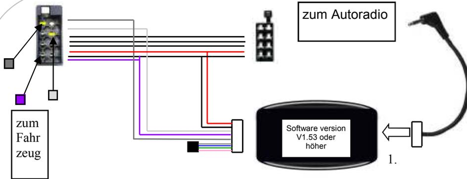
**1-Immer den Radioadapt-er anschliessen bevor die Zündung eingeschaltet wird!**
